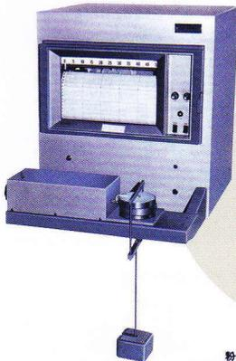
粉体の摩擦力や付着力が求められます。その数値を使いサイロやホッパーの設計に必要な傾斜角度、出口径、板圧を推測する事ができます。
